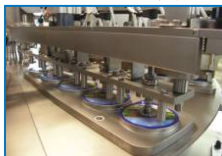
sprawdzanie zgrzewu z eliminacją wadliwych opakowań
