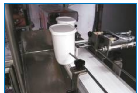
sprawdzanie zgrzewu z eliminacją wadliwych opakowań
