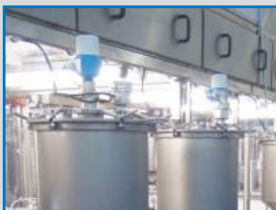
automatyczny system mycia w obiegu zamkniętym CIP
