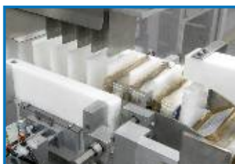
pakowanie krojonego sera na tackach w kartony typu Shelf Ready Packaging
